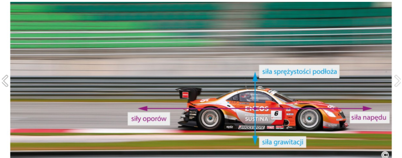
Samochód porusza się ruchem jednostajnym prostoliniowym, ponieważ siła napędzająca samochód równoważy wszystkie siły oporu. Siła grawitacji równoważy siłę sprężystości podłoża
